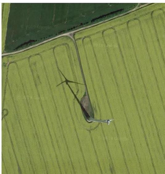
Abbildung 2: Erschließung einer Windenergieanlage parallel zur Bearbeitungsrichtung auf der Nauener Platte mit Vorgewende am oberen Bildrand (Google-Satellitenbild)
